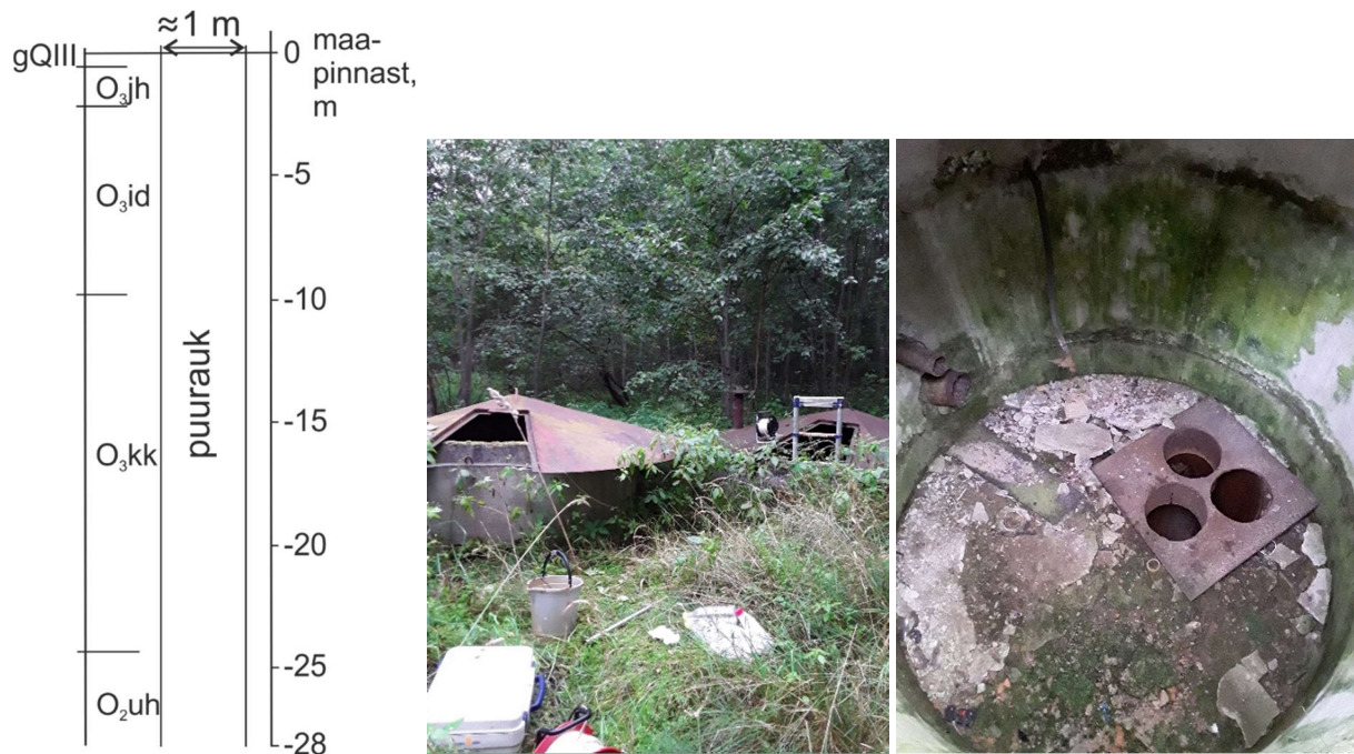
Joonis 28. Seirekaevu nr 19498 oletatav läbilõike skeem ja fotod (03.09.2019, Merle Truu).
