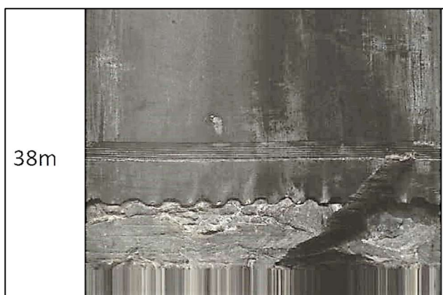
Joonis 45. Optilise kaamera pildi väljavõtte seirekaevus nr 3537 sügavuse 38 meetrit juures. Sakilise servana on näha manteltoru lõpp, paremal all servas võõrkeha. Joonise allservas olevad vertikaalsed triibud näitavad, et sond ei liigu edasi.
