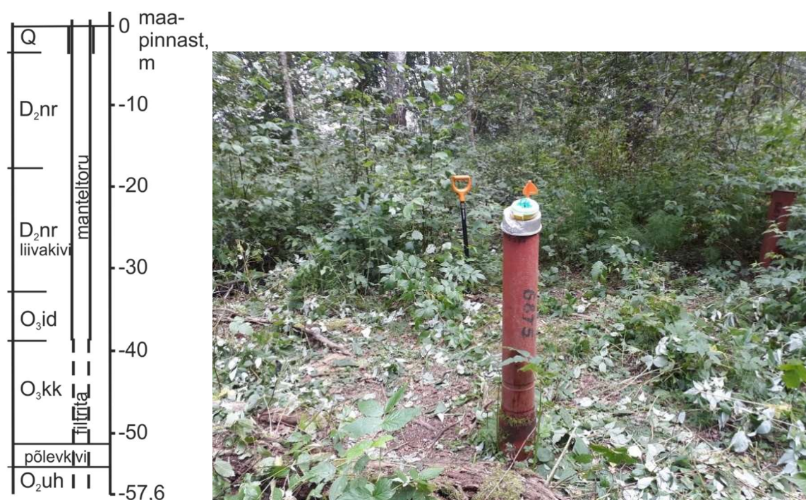
Joonis 12. Seirekaevu nr 3537 konstruktsiooni ja hüdrokeoloogilise läbilõike skeem ning foto (22.07.2021, Merle Truu)
