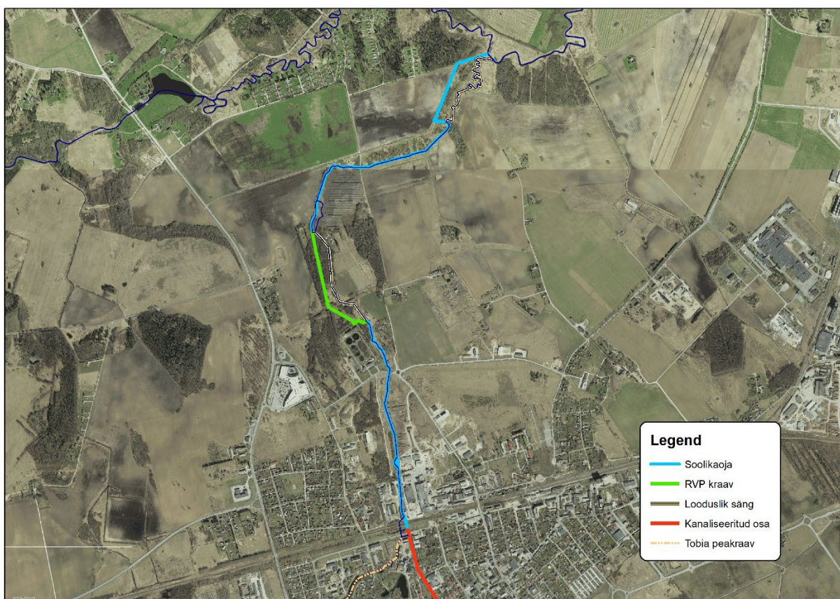
Joonis 2. Soolikaoja on alamjooksul kahes lõigus murdnud looduslikust sängist välja
