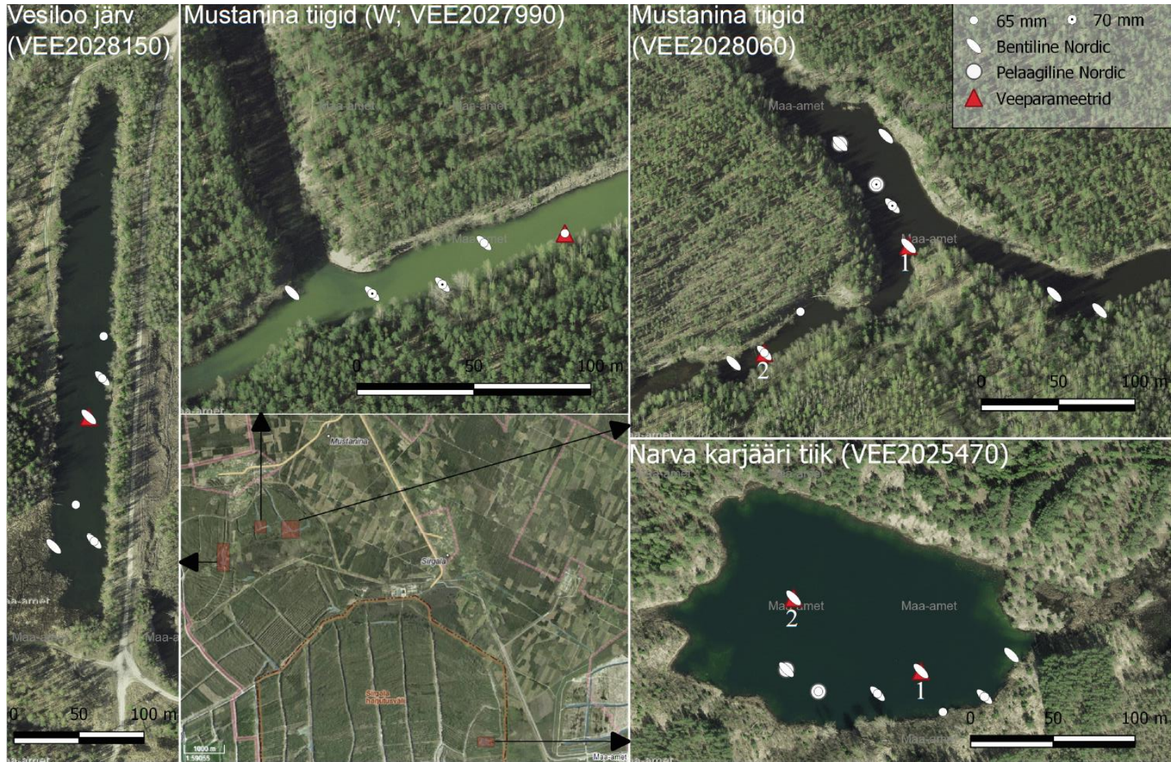
Joonis 12. Uuringuala kaart. Püügivahendite tüübid, võrkude otste asetus (valged tähised) ja veeparametrite mõõtmiskohad (punased kolmnurgad). Samanimelises veekogu puhul on läänepoolsem tähisega „W“ (joonis 12 ja tabel 16).
